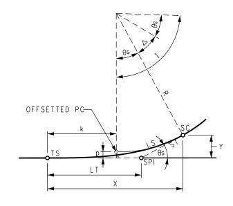
FIGURE C SPIRAL TRANSITION CURVE
