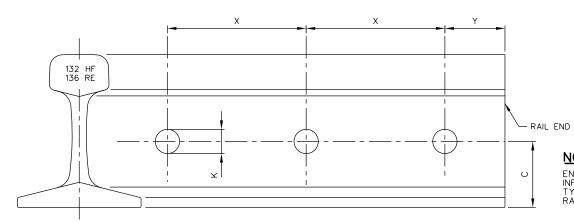
END OF RAIL DRILLING SHOWN FOR INFORMATION ONLY. END HOLE IS NOT TYPICALLY DRILLED TO FACILITATE
