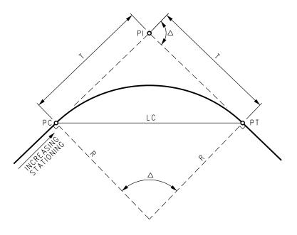
FIGURE B SIMPLE CIRCULAR CURVE
